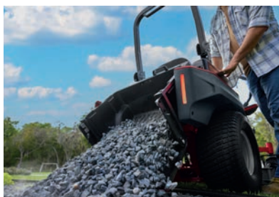
Unikátní zadní korba v porovnání s konkurencí s hydraulickým vyklápěním. Uživatelské zatížení 136kg.
