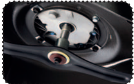
masivní sběrací nůž s třecí spojkou nože „BIG BLADE“
