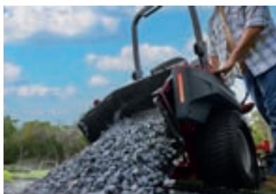
Unikátní zadní korba v porovnání s konkurencí s hydraulickým vyklápěním. Užitékové zatížení 136kg.
